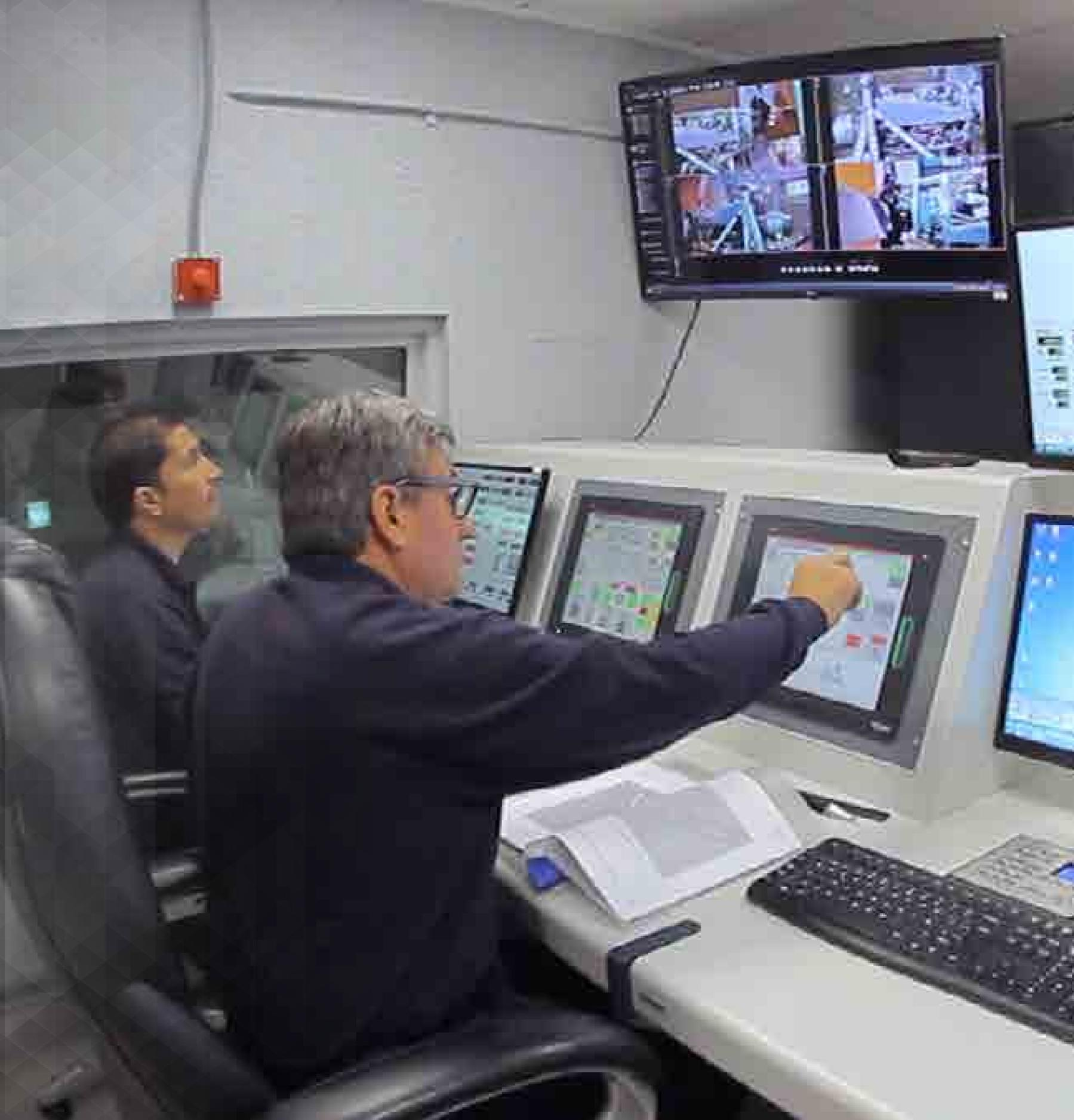
Un proyecto de alto valor agregado fue la actualización del banco de prueba de motores, elevando el nivel tecnológico de esta infraestructura mediante el mejoramiento de las instalaciones y software, lo que permitió a **ENAER** contar con la capacidad de realizar pruebas en motores T 56 de la aeronave C-130 Hércules, T 53 del helicóptero UH 1H, entre otros, agregar las pruebas de performance de motores PT6T-3B, del Helicóptero Bell 412 y PT6 A de diferentes series.
