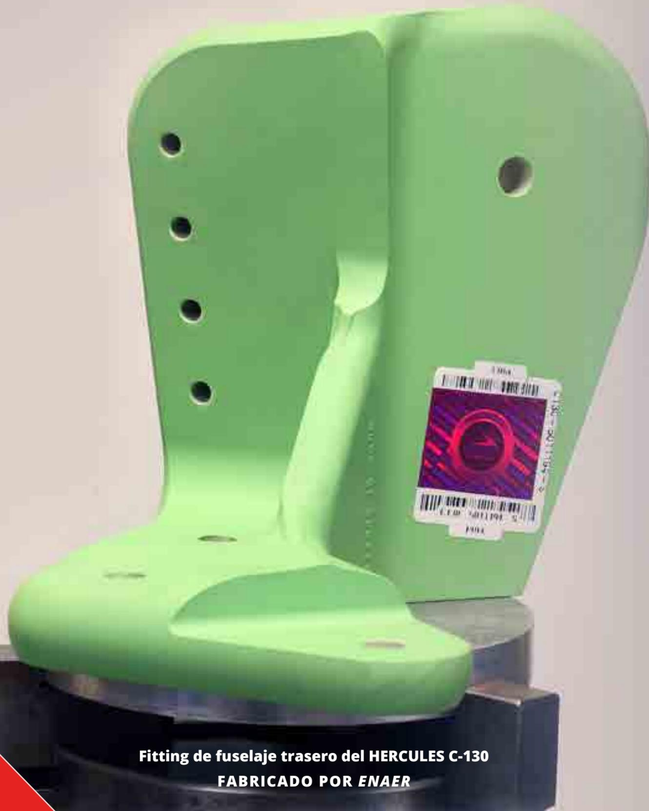
Fitting de fuselaje trasero del HERCULES C-130
