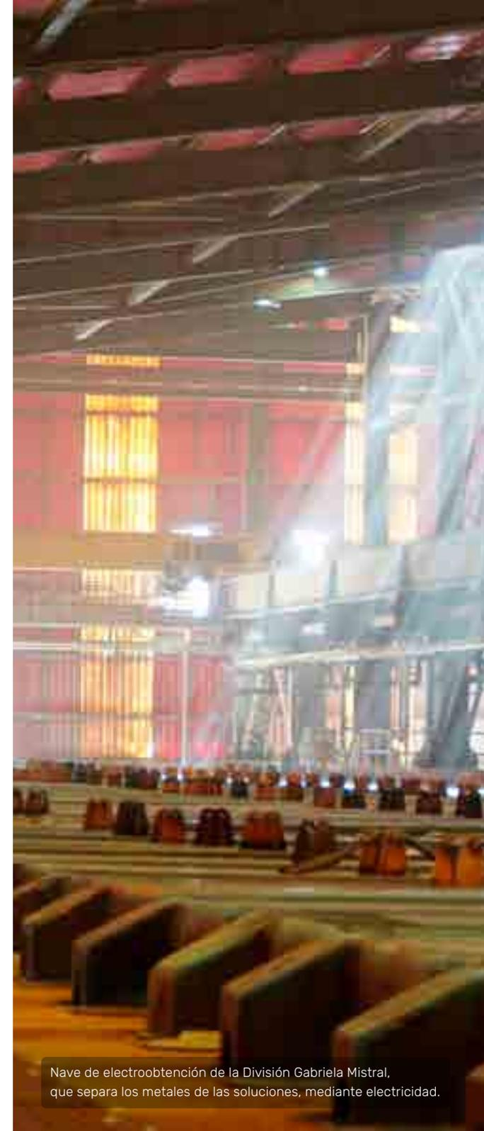
Nave de electroobtención de la División Gabriela Mistral, que separa los metales de las soluciones, mediante electricidad.
